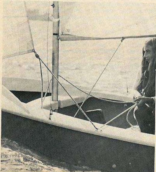
Un Vaurien moderne : coque en polyester, voiles en tergal, mât métallique...
