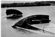
Voici, côte à côte, deux Vauriens chavirés, l'un standard (coque sombre) et l'autre muni des nouveaux volumes de flottabilité (coque claire). Alors que le bateau standard disparaît à moitié sous l'eau, l'autre coque flotte à la manière d'un 5.9.5.
