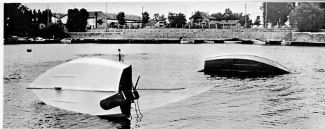
Voici, côte à côte, deux Vauriens chavirés, l'un standard (coque sombre) et l'autre muni des nouveaux volumes de flottabilité (coque claire). Alors que le bateau standard disparaît à moitié sous l'eau, l'autre coque flotte à la manière d'un 5.9.5.
