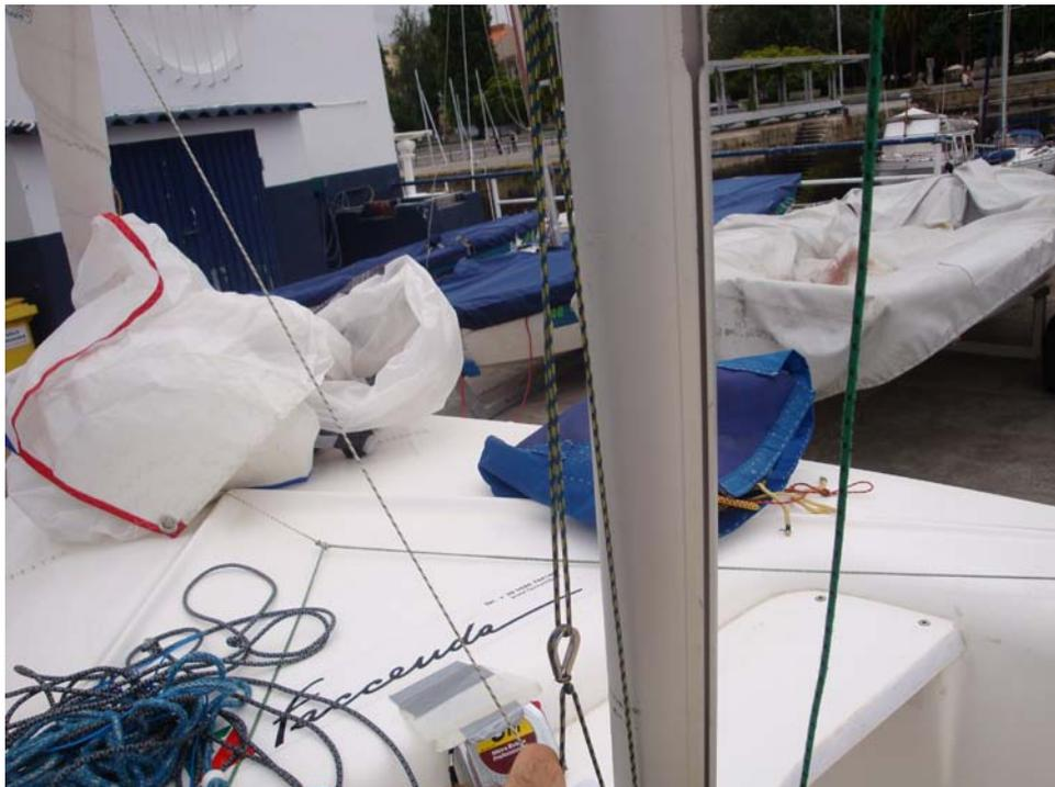
Dans ce cas, le circuit de balancine est vertical, et parallèle au mât, sans taquet, avec un système 2-3 (voir chapitre 2), qui est très accessible et facile à régler.
