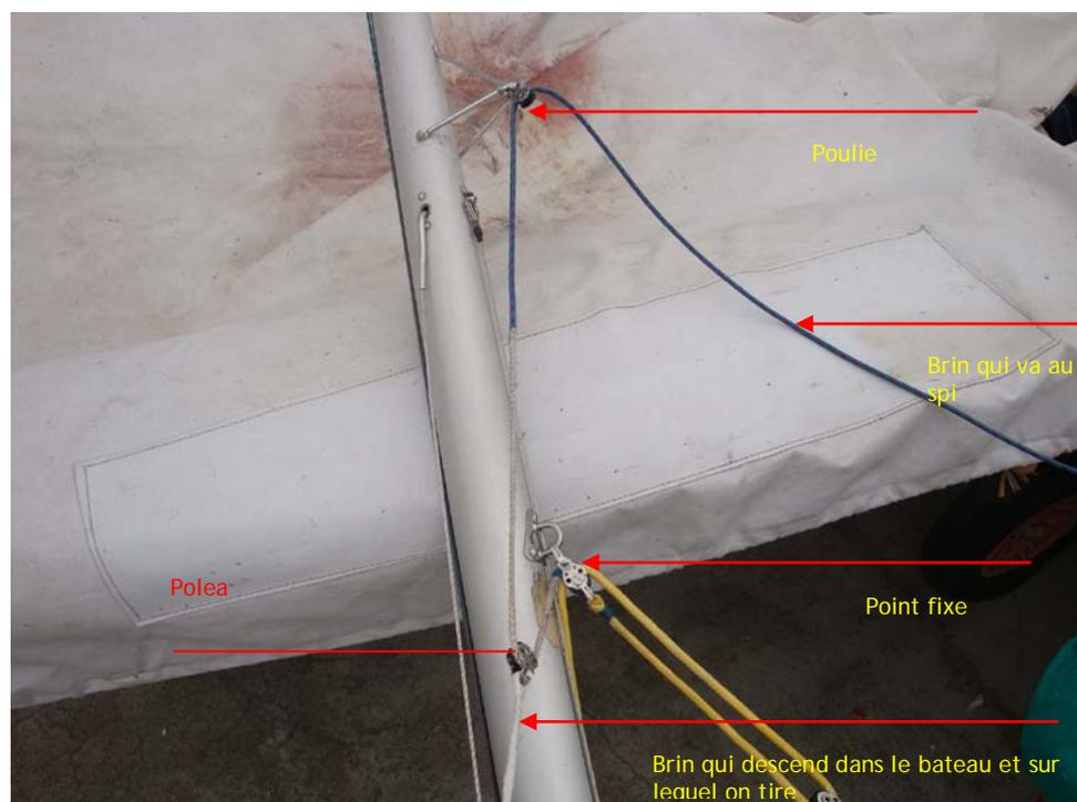
On a monté la drisse en deux parties ; on met l'ancrage du foc à profit pour le point fixe.
