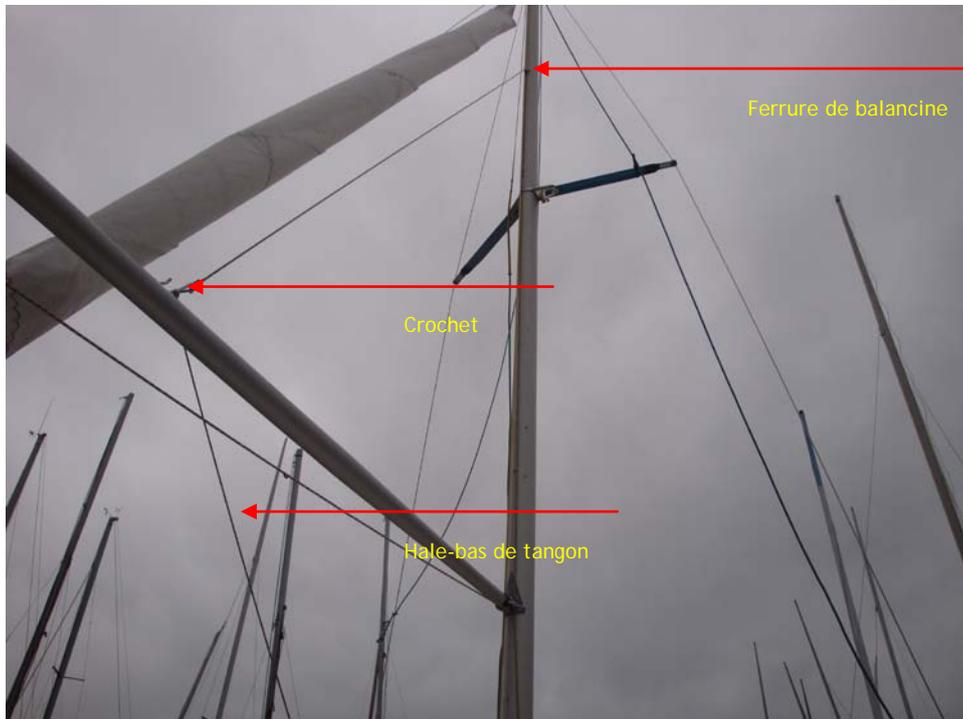
Il faut dire que le crochet de la balancine est une pièce relativement facile à trouver dans un magasin d'accastillage, bien que ce soit réellement quelque chose de très simple que vous pourrez bricoler. (Pendant de nombreuses d'années j'ai utilisé comme crochet une manille sans manillon, et mon équipier n'était pas disposé à le changer par un autre crochet plus "design").
