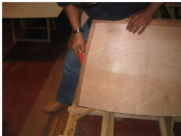
Realizando la curvatura longitudinal del mamparo
