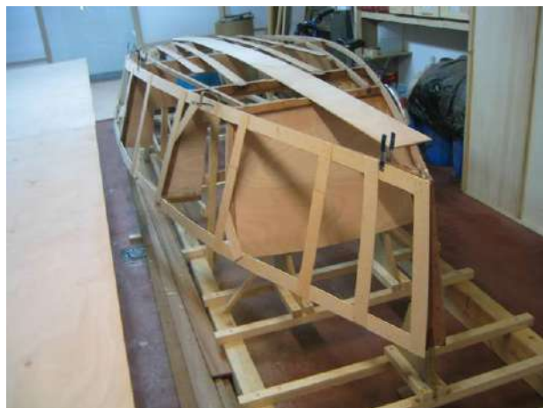
Preparación de plantilla para forro
