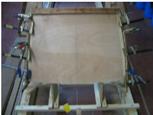
Encolado de listones soporte de forro
