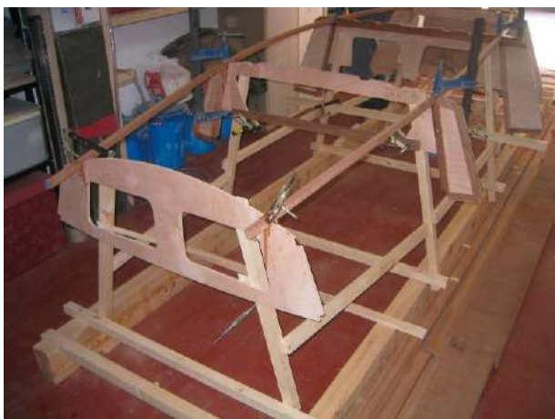
Colocación de listones interiores
