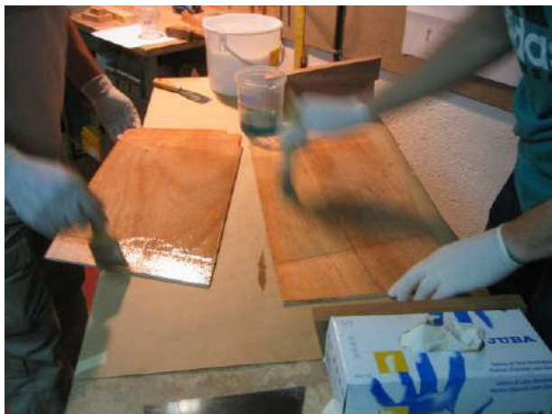
Impermeabilizando la caja de orza
