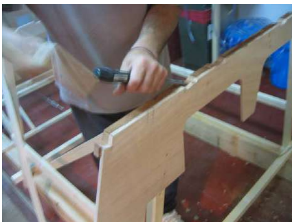
Vaciado de los recesos
