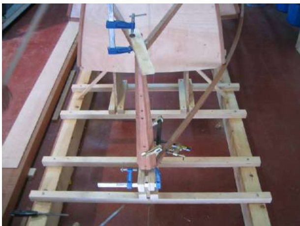
Colocación del listón de borda
